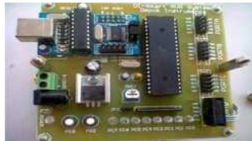
**Gambar 2.4** Bentuk Fisik *DI-Super Smart AVR16*
