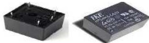
**Gambar 2.2** Bentuk Fisik Relay
